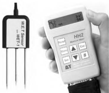
图 1 WET 土壤水分温度电导率速测仪
