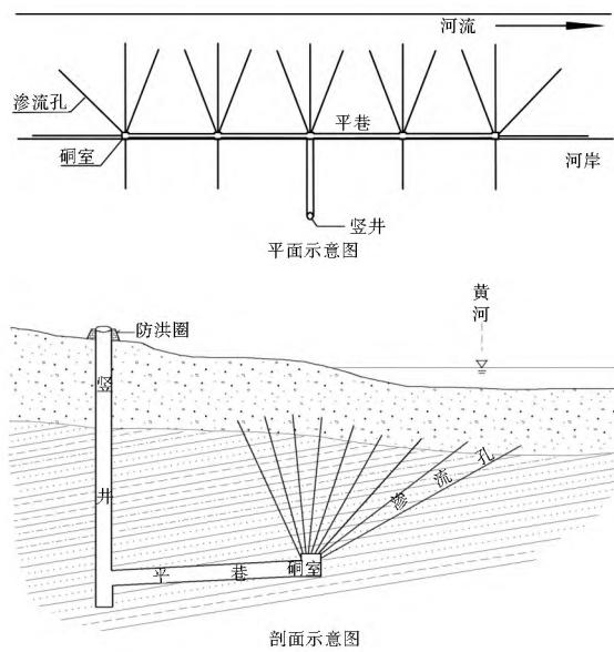
图 1 渗流井取水结构示意图
