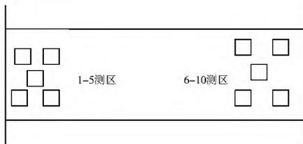
图 1 甲、乙检测单位对比回弹测区布置
