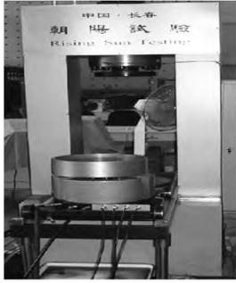
图 1 TA W-2000 电液伺服三轴刚性试验机
