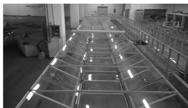
图 5 试验水槽 Fig. 5 Test flume
