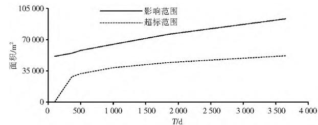
图 4 防渗破損时氨氮运移面积历时曲线
