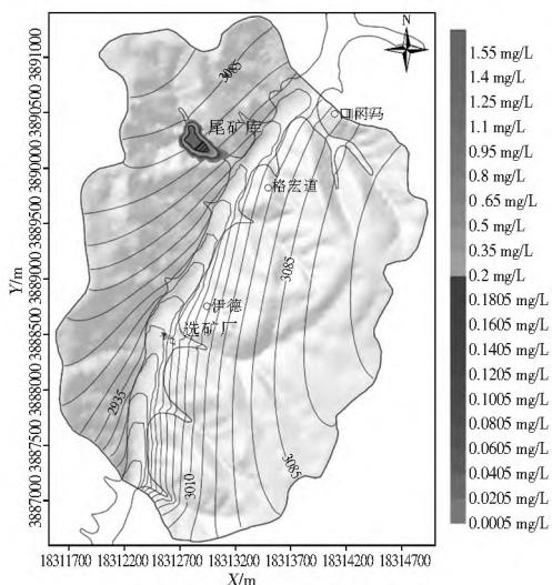
图5 尾矿库防渗层破损时10年氨氮的迁移
