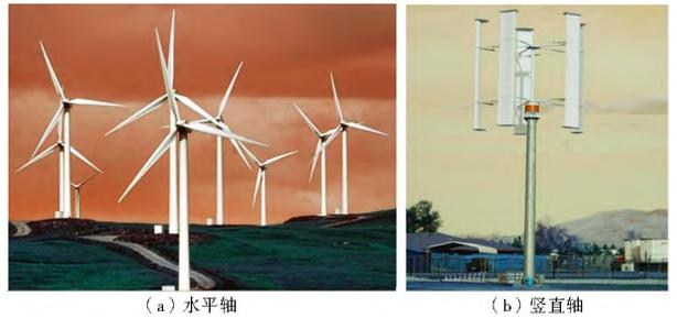
图 7 桨叶式风力发电机
