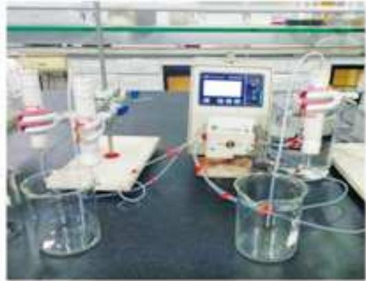
图 1 GT-NIP 去除模拟地下水中  $\text{Cr(VI)}$  的柱试验装置
