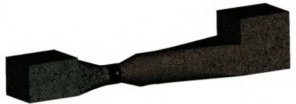
图 1 卧式灯泡贯流泵三维模型及其网格
