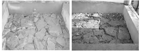
(a) 1号无填充实验池 (b) 2号有填充实验池
