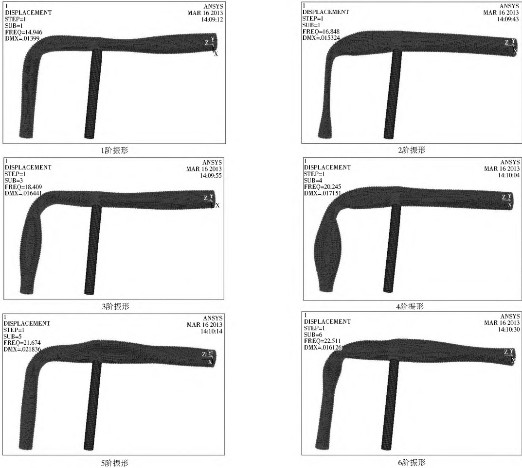
图5 工况一前6阶模态振型
