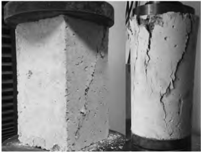
图 8 试件典型破坏形态图
