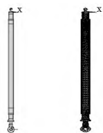
图 4 油缸整体模型及有限元分网
