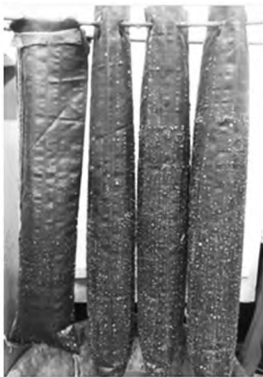
图 5 小吊袋沉淀试验装置
