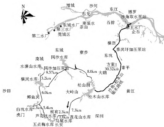
图1 东莞市东江与水库联网工程总体布置示意图
