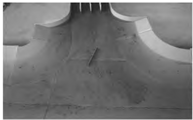
图 7 方案 4 导流墙流态
