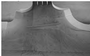
图 8 方案 5 4 cm 窄底坎流态
