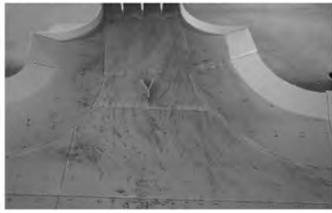
图 5 方案 2“Y”型导流墩流态
