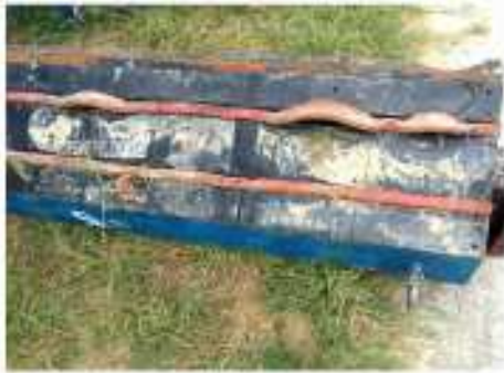
图 17 底座膨胀条纵向膨胀后脱出卡槽
