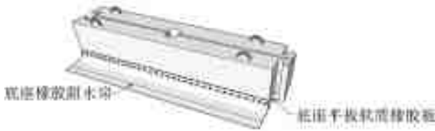
图14 底座止水构造
