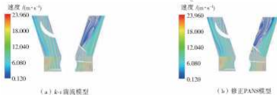
图 6 转轮及导叶截面 2 流线
