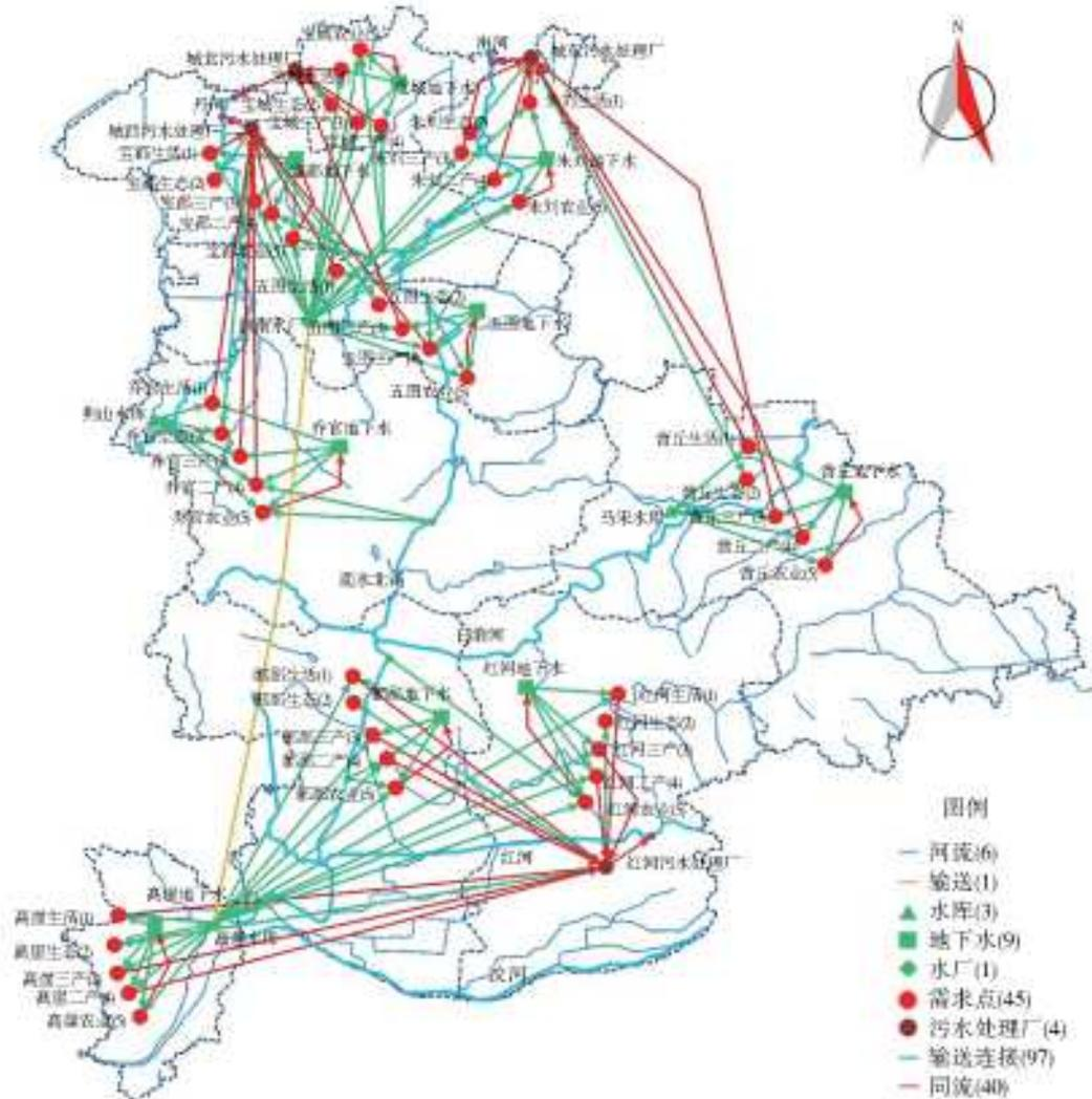
图2 昌乐县 WEAP 模型概化
