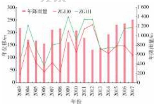
图 4 监测年度位移—降雨量变化曲线 (2003年7月—2017年12月)
