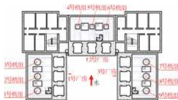
图 1 泵站机组平面布局
