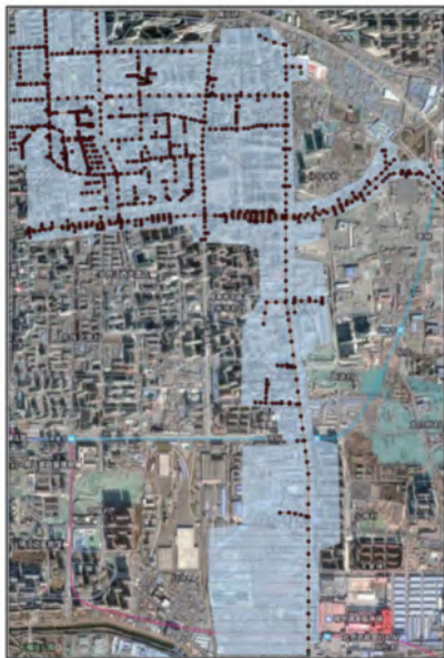
图 6 人工绘制法划分研究区域汇水区
