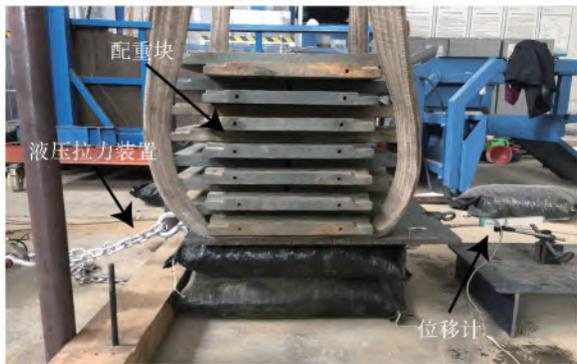
图 11 土工袋袋体层间摩擦试验
