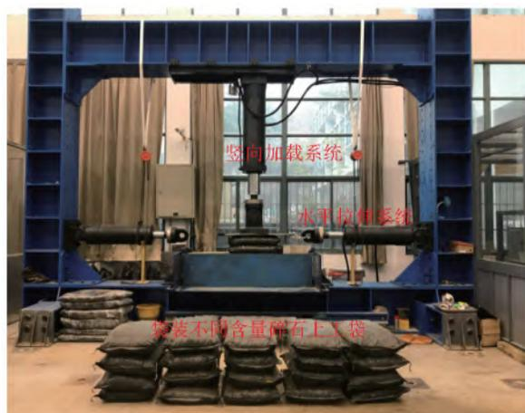
图 4 土工袋摩擦试验装置
