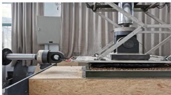
图 14 土工袋袋土之间摩擦试验
