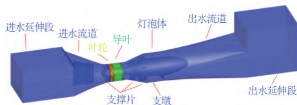
图 1 泵站灯泡贯流装置三维计算域
