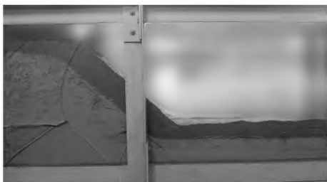
图5 渠坡浅表膨胀土内麻窝分布,PH层间张缝
