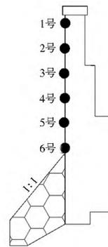
图 5 挡浪墙压力传感器布置图
