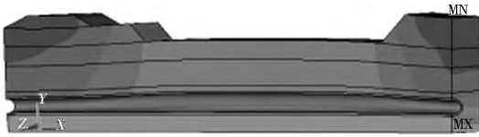
图4 管道竖直位移云图
