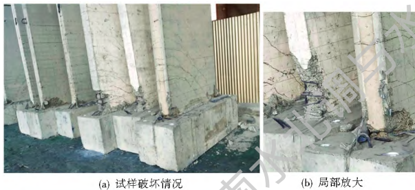
图4 结合面强度试验结果
