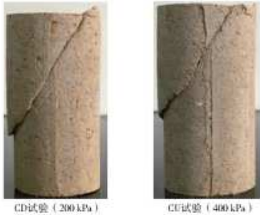
图 5 三轴试验试样破坏形态
