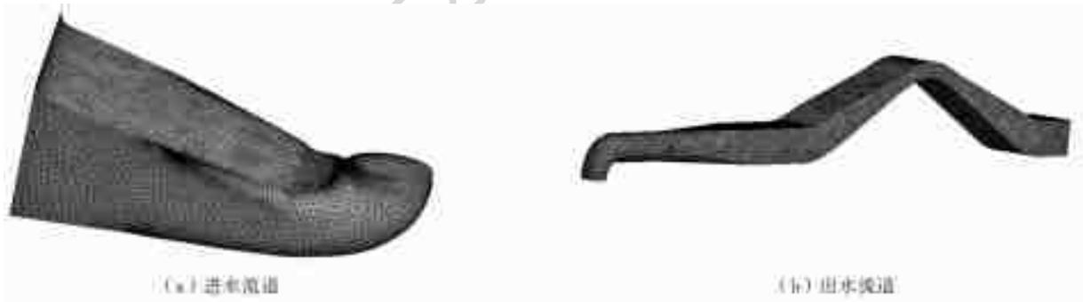
图 3 进出水流道计算网格示意图
