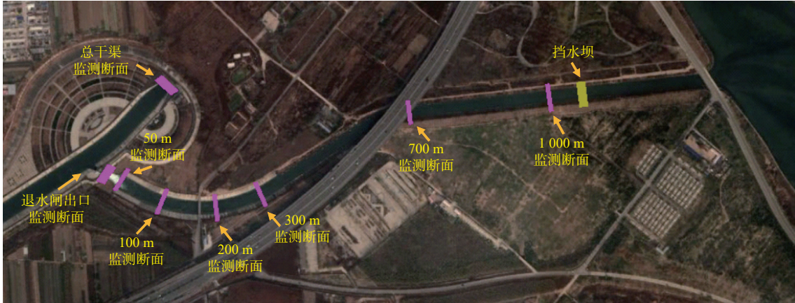
图 2 现场试验范围及监测断面布置
